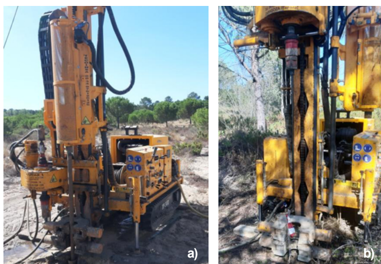
Fig.3 – Sonda Tecoinsa Noemi TP 30D: a) Sondagem S1 ; b) Sondagem S4
